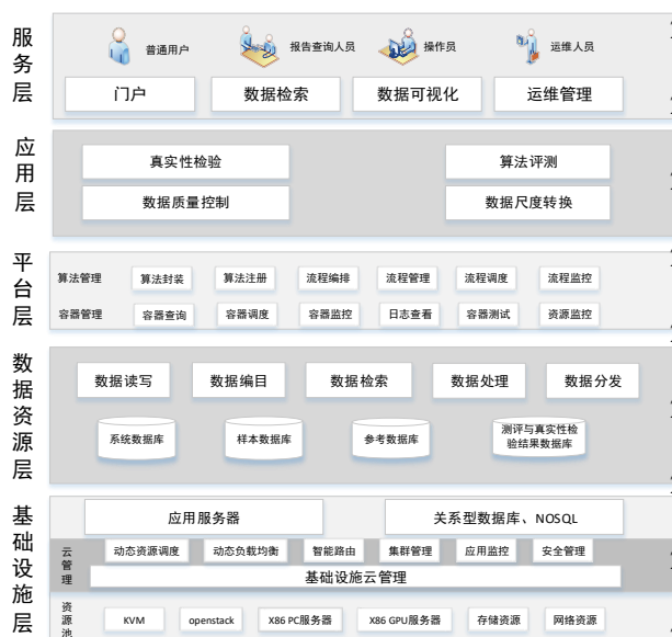
图 4 高分共性产品真实性检验与算法测评架构图
