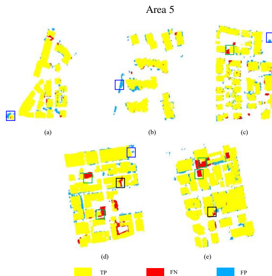
图6 建筑物提取投影面积可视化结果，(a)区域1，(b)区域2，(c)区域3，(d)区域4，(e)区域5
