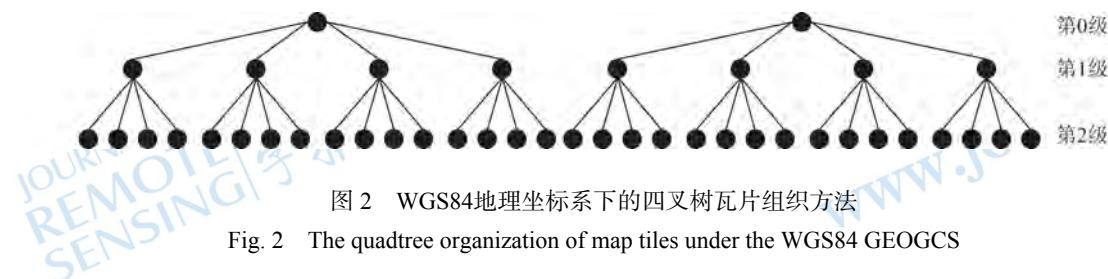
图2 WGS84地理坐标系下的四叉树瓦片组织方法
