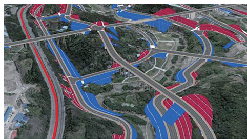
(c) 面向道路规划的填挖方计算
