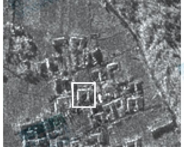
图 9 农村地区建筑物毁损的 SAR 图像
